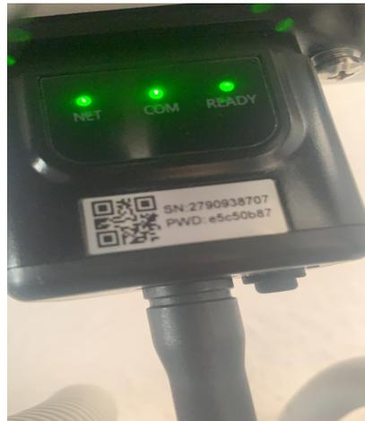
**SI LAS LUCES ESTAN CORRECTAS PODEMOS CONTINUAR,** de lo contrario tendríamos que reiniciar la antena con el botón negro que está en su lateral, esperamos que se regenere y luego comprobamos , si las luces siguen de manera errónea no cogerá la configuración tiene que ir un técnico al domicilio no continúe los pasos.
