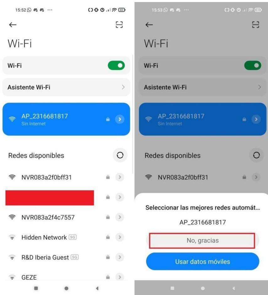
**4.-** Una vez conectado a la red WIFI del inversor tenemos que irnos a un NAVEGADOR (**Google Chrome**, se recomienda usarlo si tiene androide \*\*Si usted tiene un dispositivo **Apple** es recomendable utilizar el navegador **Safari o EDGE**) y colocar la siguiente dirección IP: 10.10.100.254 y darle a Buscar.
